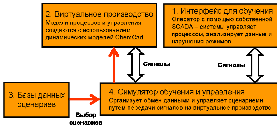
Рис. 12. Принципиальная схема функционирования тренажёрного комплекса с динамической (имитационной) компьютерной моделью.
