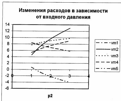
Рис. 3. Статистические характеристики гидравлической системы: изменения режимных параметров в зависимости от одного из давлений на входе - p2
